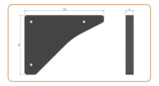
La plaque de guidage est placée sur le fond contre le côté de l'armoire à 40 mm de l'avant.
