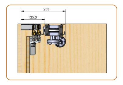
La bielle est aussi parallèle que possible au panneau de la porte, bien que cela ne soit pas critique. Logiquement, le module « tire » la porte vers le haut et la « pousse » vers le bas. La distance H correspond à la position horizontale de la pièce d'angle de connexion et est déterminée lorsque la porte est fermée et que le chariot du module est en posi-
